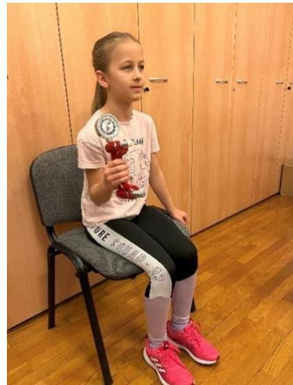
Slika 19: Ručni kalibrirani dinamometar
